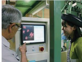
▲全長15m・製品幅最大14mのエンプロイダリーレース機(刺しゅうレース製造機)。軽快な作動音とともに、繊細で可憐な模様が刺しゅうされていく様子は圧巻です!
