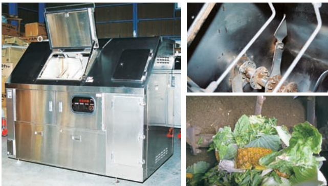
▲同社が誇る「生ごみりサイクルシステム」の基幹となる「ゼロワンダー」。傾斜のある大きな投入口、撹拌効率・破砕効力の高い撹拌羽根、活性炭吸着式の脱臭層など、作業効率を追及した独自の創意工夫が随所に生かされています
