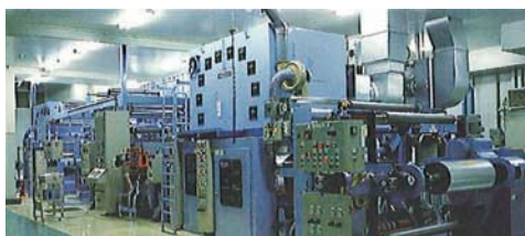
▲フィルムを複数層貼り合わせる「押出ラミネーター」
