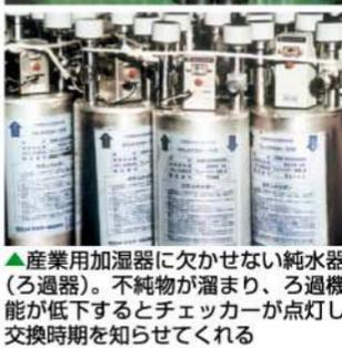
▲産業用加湿器に欠かせない純水器(ろ過器)。不純物が溜まり、ろ過機能が低下するとチェッカーが点灯し交換時期を知らせてくれる
