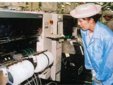
▲リール状にセットしたチップをSMD実装ラインで基板に装着。本社工場では12ラインが24時間フル稼働に対応
