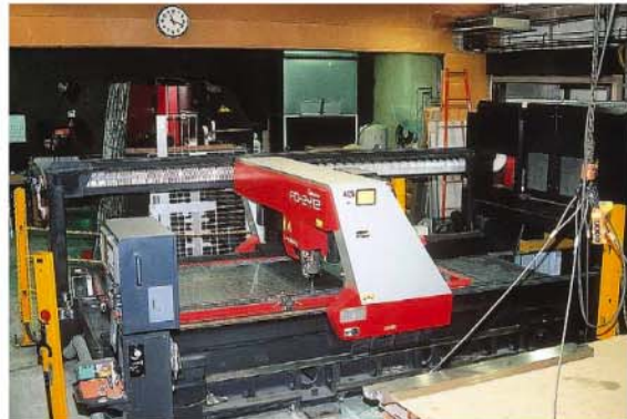
▲2階のオペレータ室と1階のNC各機は、高速光ケーブルで直結。仕事の効率化と精度向上にIT導入は欠かせない要素。
