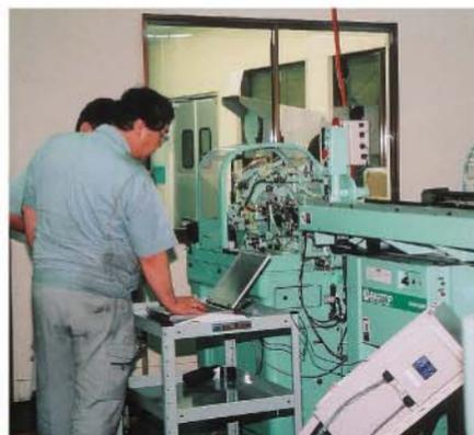
▲旧型のカム式自動旋盤機は、自社内で改造してグレードアップ。「職人の力」が現場を支えています
