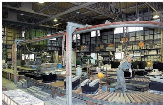
▲作業場にはローラーコンベアが敷かれ、重い砂型も迅速に次の工程へと流れていきます。機械化+創意工夫のものづくり
