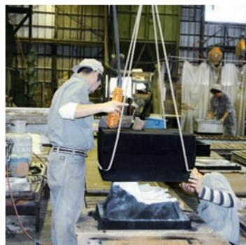
▲クレーンで吊りながら、砂型の上下を合体させる。息を合わせて、緊張の瞬間
