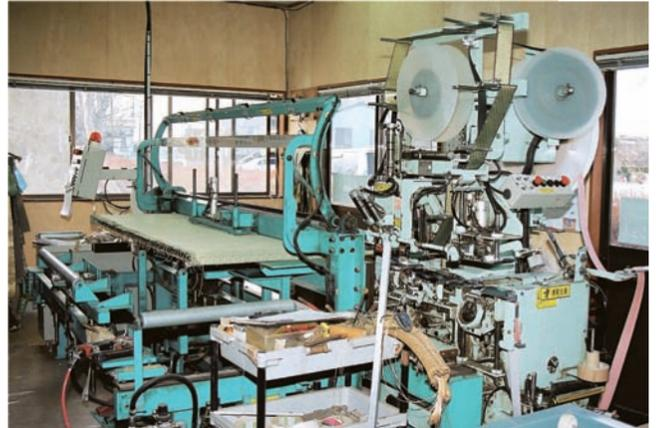
▲コンピュータシステムによる大型機械は特注品。寸法取りから畳縁の縫い付け仕上げまで、すべて機械化することで効率アップ。少人数でも作業可能
