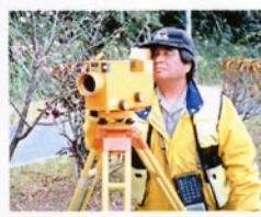
▲1ミリの百分の1まで正確に測定する「一等水準測量」は高度な専門技術です(2000年1月電気大賞にて)
